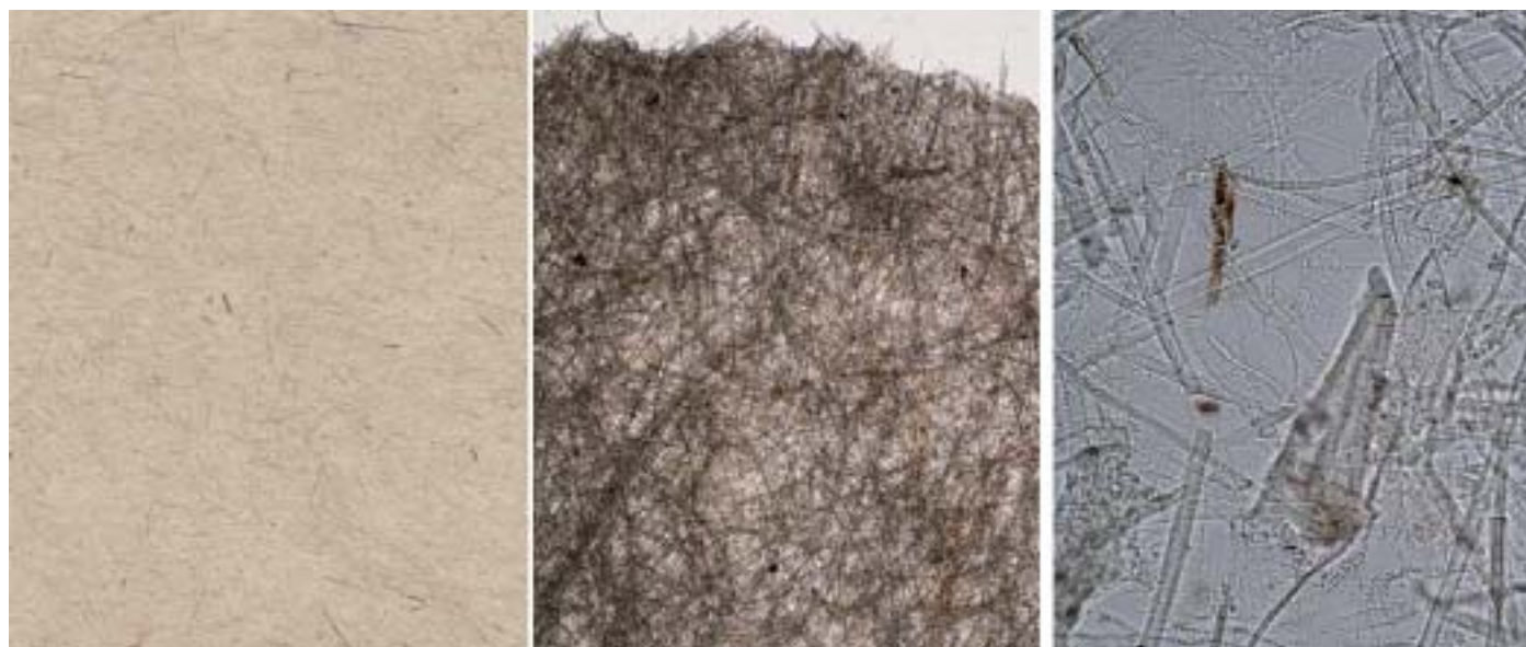
3-5. irudiak. 3: Cortaderia selloana ren zuntzez egindako papera; 4: +50ko handipeneko mikroskopioan, zuntzetako egitura nahaspilatua nabarmentzen da; 5: 150-ko handipenaz, trikomak, parenkima-zelulak eta abar bereizten dira.
