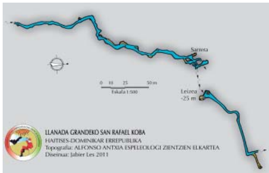
Llanada Grandeko San Rafael kobaren topografia. Kobak 250 m-ko luzera du, eta ura du ibilbide osoan. Sarrerek 1,40 m-ko altuera du, baina hortik aurrera soilik metro batekoa da. Galeriaren azkeneko zatia sifoi bihurtzen da, hau da, urez betetzen da, eta hantxe sortzen da iturburu. ARG.: JABIER LES.
