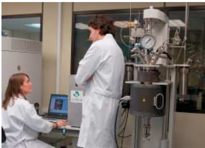
GAIKER-1K4ren azken belaunaldiko PARR erreaktorea. Erreaktore hori erabiliko dute REQUIPLAST proiektuan.
