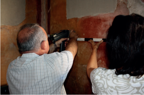
X izpien fluoreszentzia espektrometroaren erabilera, Marcus Lucretius horma-margoak aztertzeko.
